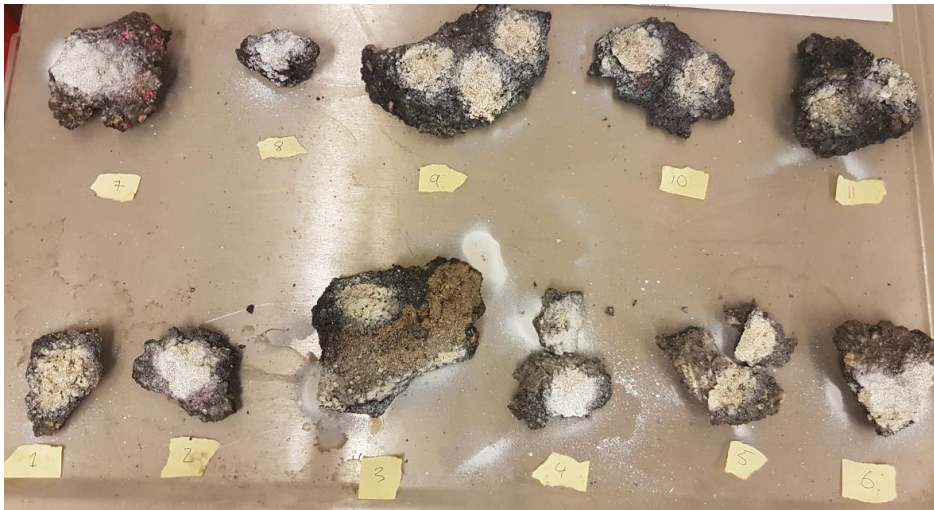
Figur 2. Sprayade asfaltsprover från samtliga provpunkter.
