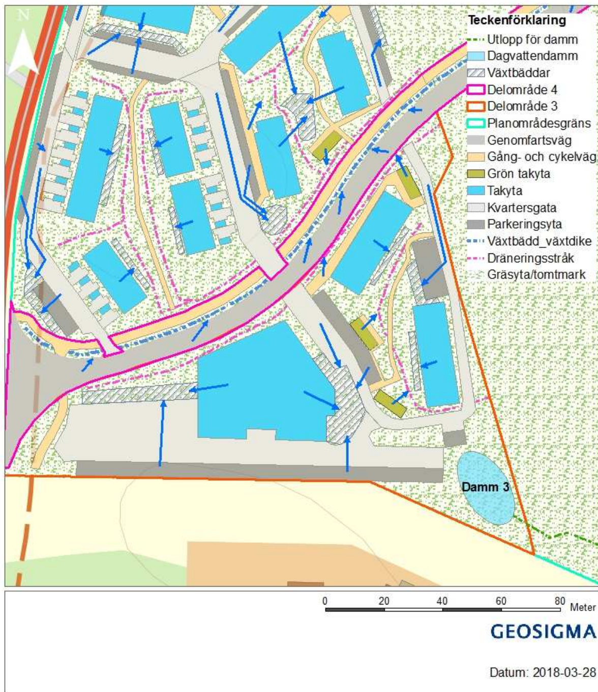
Figur 5-3. Lösningförslag med växtbäddar och dagvattendamm för Delområde 3.
