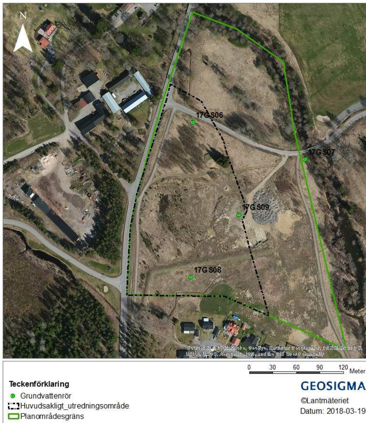
Figur 3-11. Grundvattenrör inom planområdet.
