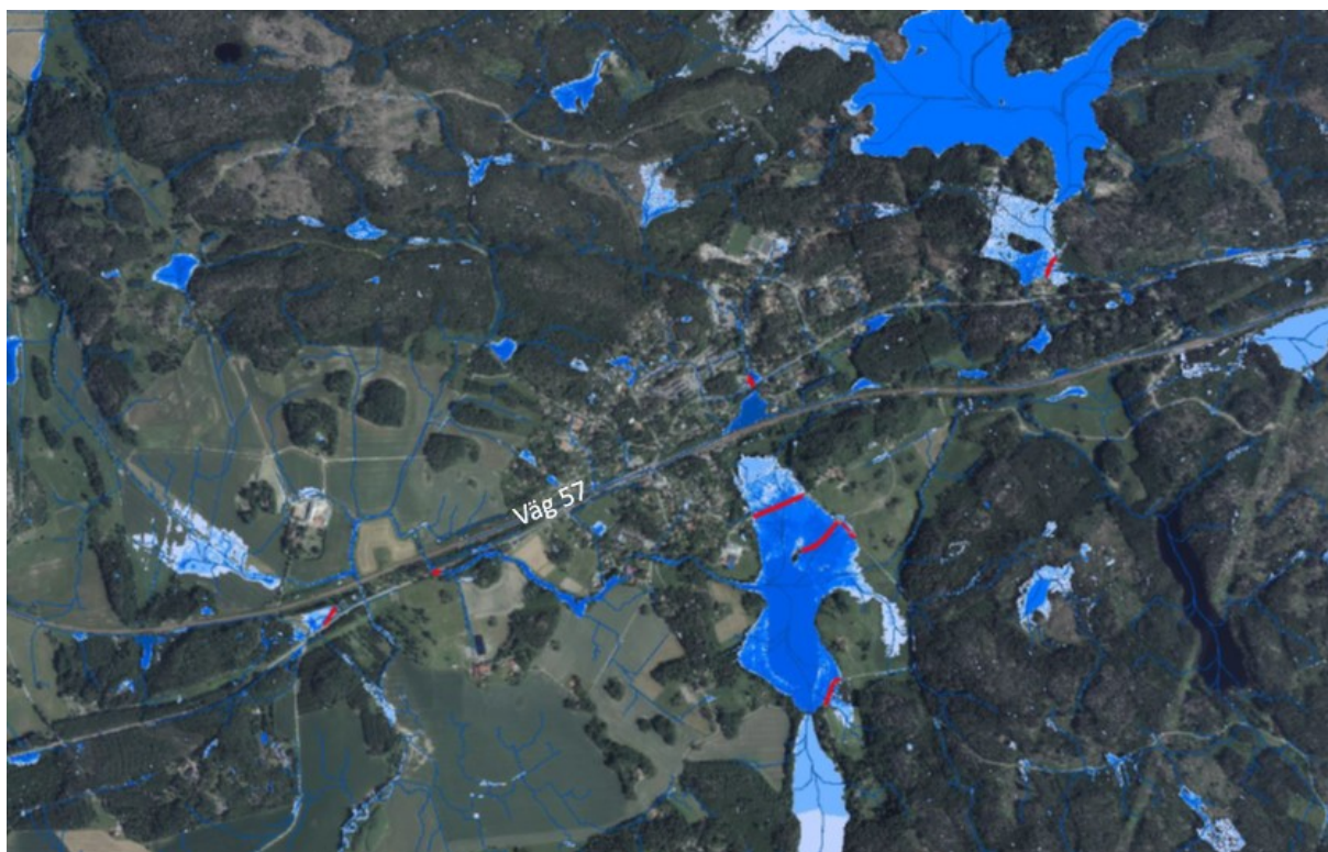
Figur 34. Vägsträckor med begränsad framkomlighet till och inom Mölnbo tätort markerat i rött. Beräknade vattendjup är över 0,2 m och arean på översvämningsutbredningen är över 100 m 2 , blåa fält översvämningsutbredning och tunna blå linjer visar flödesstråk vid skyfall.
