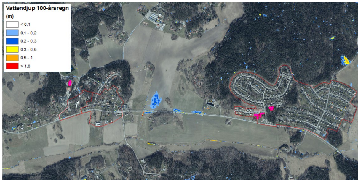
Figur 27. Byggnader inom kategorin samhällsfunktion inom Ekeby och Tuna som riskerar att drabbas av översvämning med ett vattendjup över 0,1 m vid skyfall (rosa byggnadspolygoner). Verksamhetsområde för VA visas med röd linje som ungefärlig markering av tätorten. Översvämningsdjup är från Scalgoanalys.
