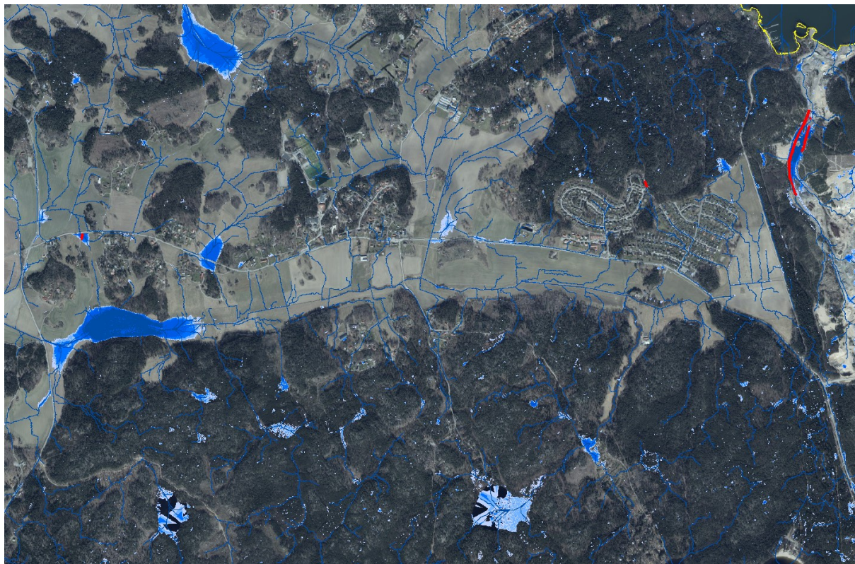
Figur 35. Vägsträckor med begränsad framkomlighet till och inom Ekeby och Tuna markerat i rött. Beräknade vattendjup är över 0,2 m och arean på översvämningsutbredningen är över 100 m 2 , blåa fält översvämningsutbredning och tunna blå linjer visar flödesstråk vid skyfall.
