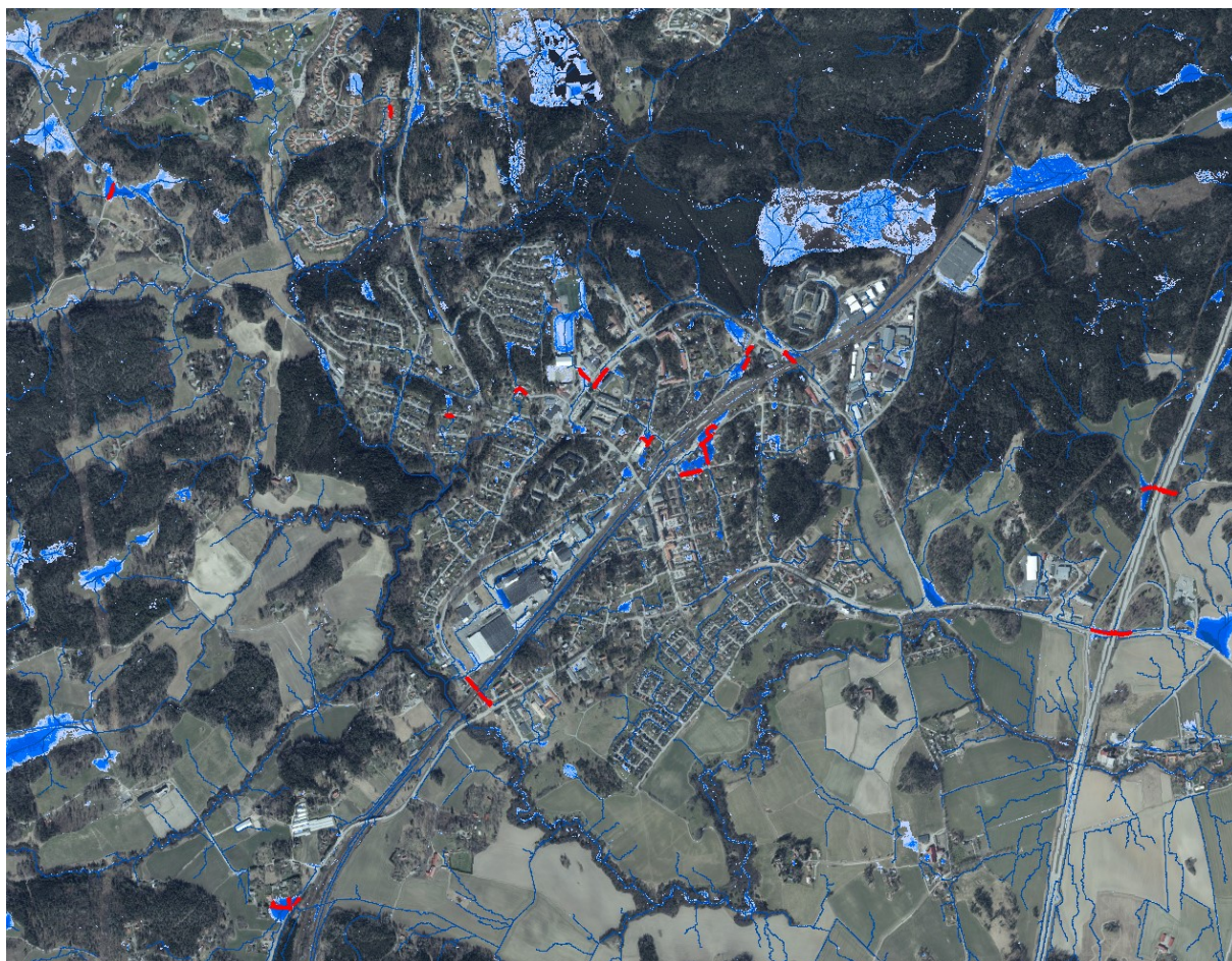
Figur 32. Vägsträckor med begränsad framkomlighet inom Järna tätort markerat i rött. Beräknade vattendjup är över 0,2 m och arean på översvämningsutbredningen är över 100 m 2 , blåa fält översvämningsutbredning och tunna blå linjer visar flödesstråk vid skyfall.
