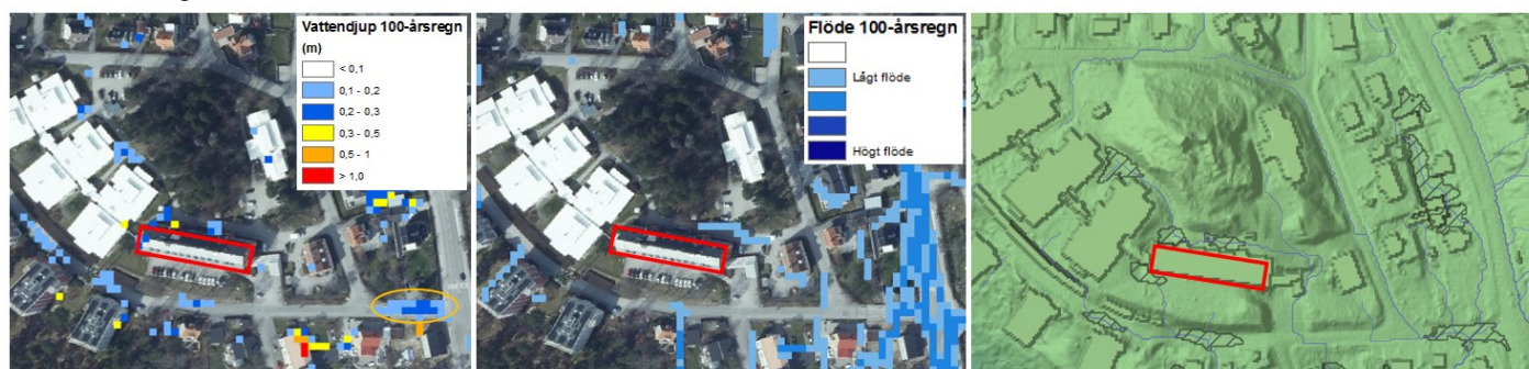
Figur 20 Beräknade vattendjup (till vänster) och flödesvägar (i mitten) vid Tallhöjdens vårdcentral samt lågpunkter invid fasaden (till höger). Orange cirkel markerar lågpunkt på Bruksgatan där det ansamlas vatten vid skyfall.
