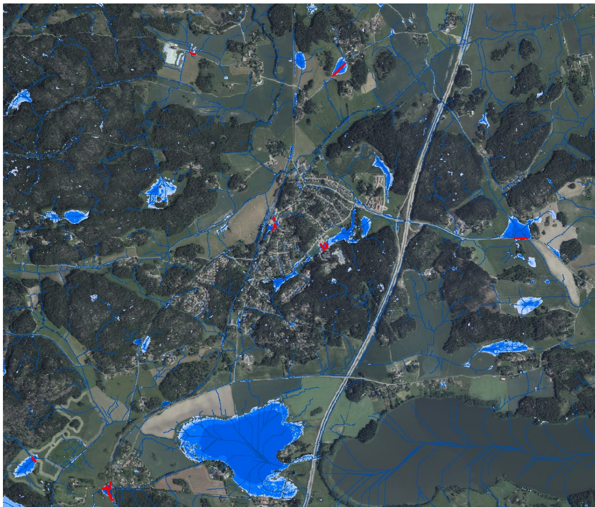
Figur 33. Vägsträckor med begränsad framkomlighet till och inom Hölö tätort markerat i rött. Beräknade vattendjup är över 0,2 m och arean på översvämningsutbredningen är över 100 m 2 , blåa fält översvämningsutbredning och tunna blå linjer visar flödesstråk vid skyfall.
