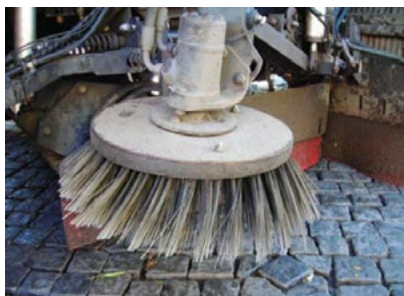
Bild 7. Stålborstar går hårt åt fogarna.
